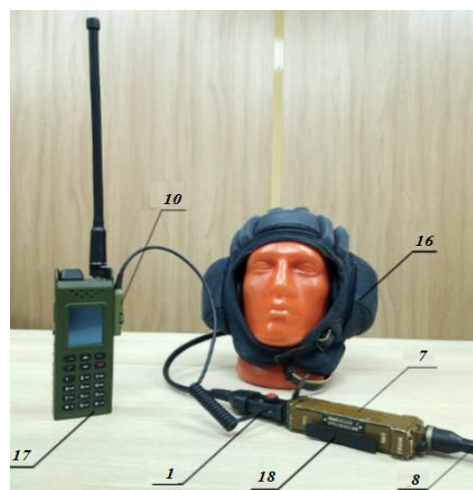
Рис. 4. Общий вид модуля коммутации в сборе с шлемофоном и портативной радиостанцией
