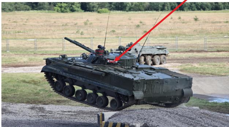
Рис. 1. Боевая машина пехоты БМП-3 с закрепленной на башне портативной радиостанцией «Азарт»
